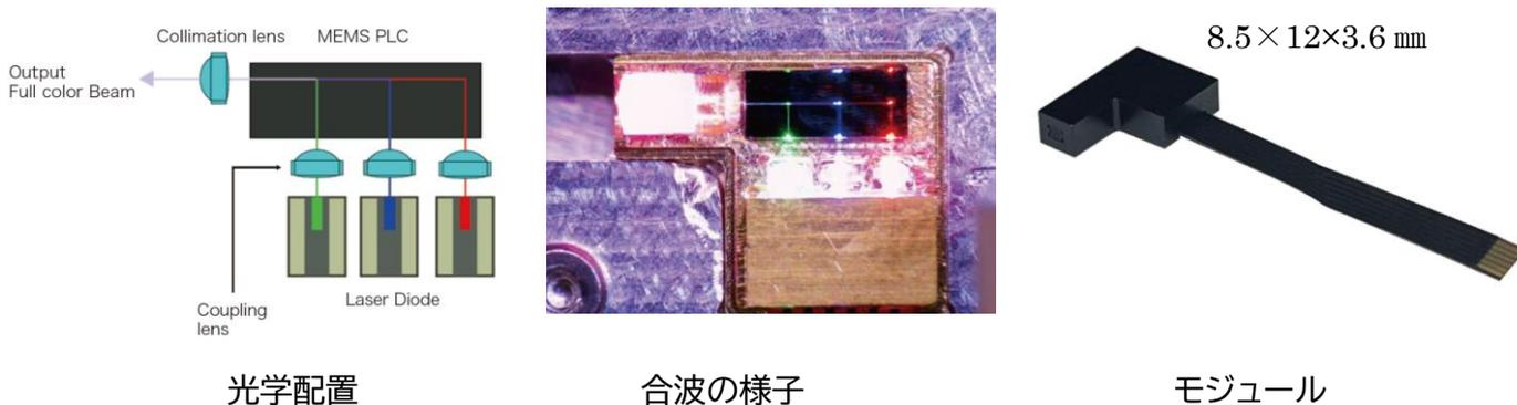
図. RGB レーザー光源モジュール
